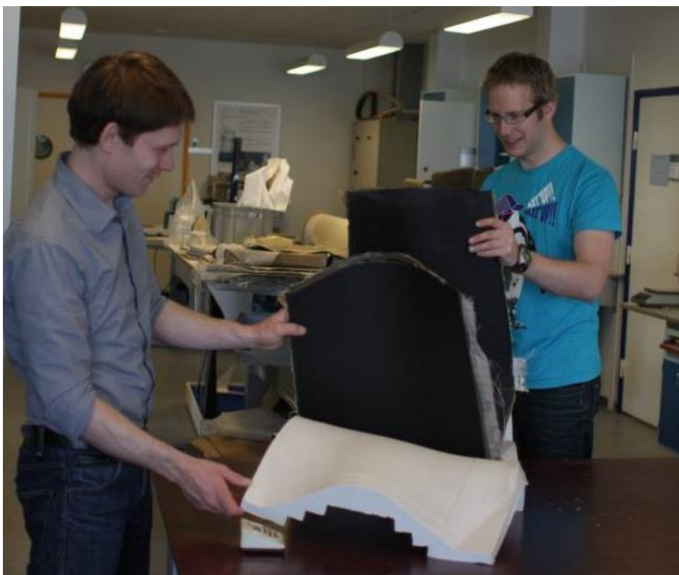
Figur 6.5.8 På billede ses to tilfredse designere Martin Larsen og Henk Hatzmann, der netop har løftet de ca. 32 kg silikoneform og emne ud af supportkassen, hvorefter silikoneparten selv slipper fra emnet.
