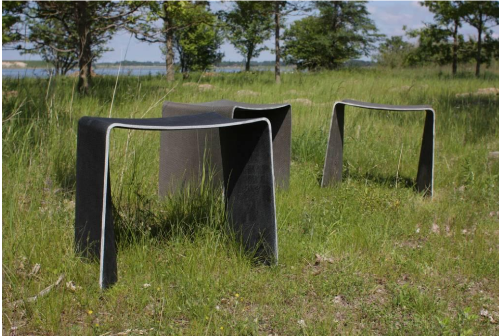
Figur 1.2.1: Skammel med negative slipform og med strukturen fra det væv der er benyttet til fremstilling af emnet i overfladen. Skammelen er resultatet af en ny procesmetode udviklet i projektet.
