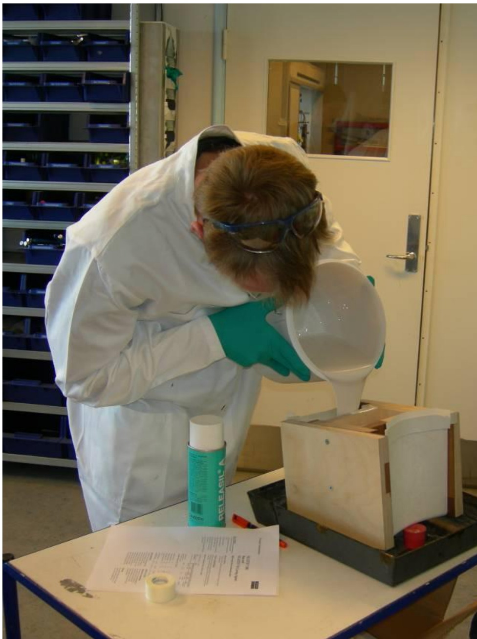
Figur 5.2.6: Støbning af silikonegummi i form fremstillet ved hjælp af krydsfiner og en SLA model af en skammel. Formen er skråstillet for at undgå luftindeslutninger når silikonegummimassen hældes i formen.
