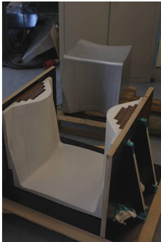
Figur 6.5.4 Silikoneformen placeret i sin supportkasse klar til oplæg af materiale. Bag formen kan aluminiumformparten ses.
