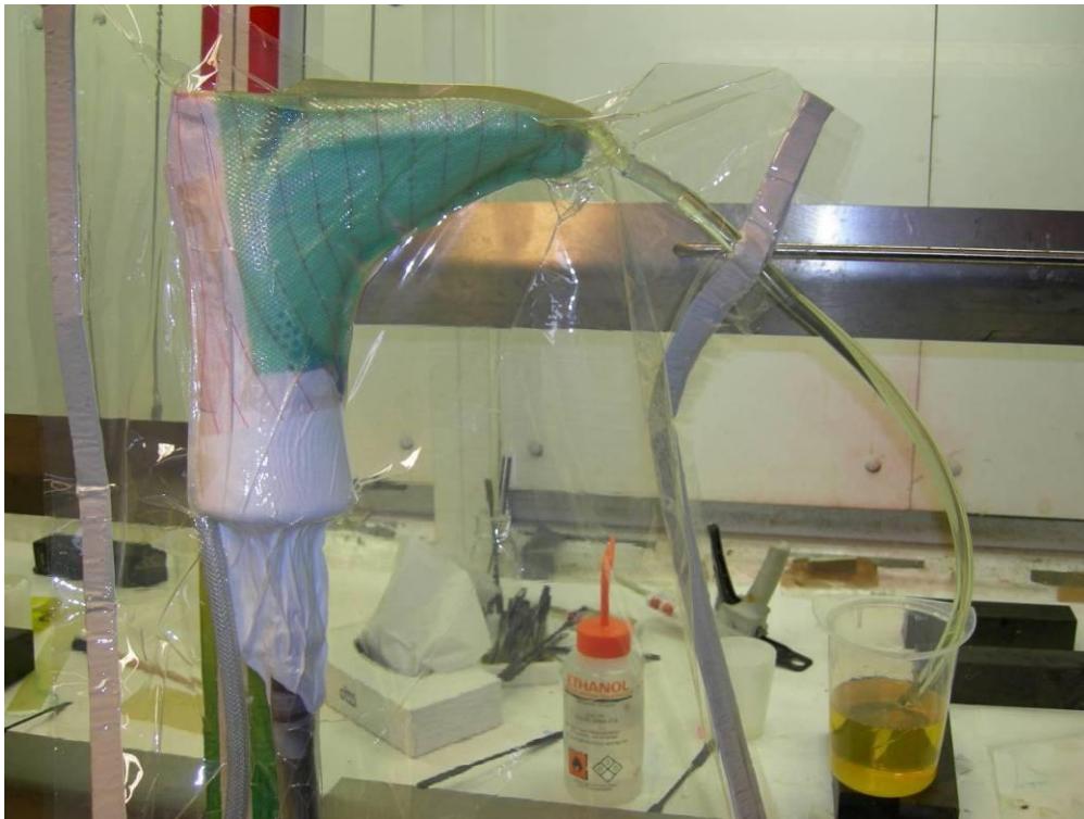
Figur 6.2.2: Vakuump infusion af dropfodsskinnen. Vædningen af fibrene kan ses som de mørkere områder på emnet. Flowfronten blev med succes etableret med en forgrenet "inlet" slange og en "outlet" slange placeret i hele omkredsen for enden af gipsafstøbningen.
