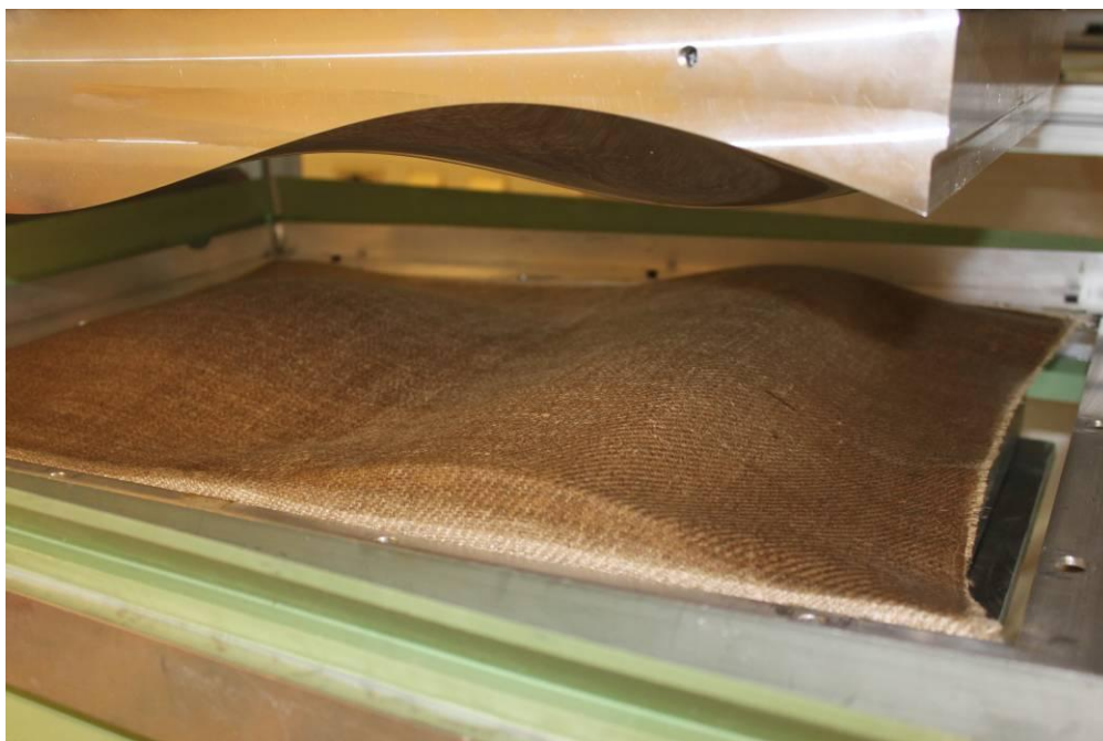
Figur 5.1.8: Pressestempet med den nederste formpart er ved at løfte materialet og rammen ud af transportøren. Når formdelene lukker sammen formgives kompositmaterialet. Trykket og afkølingen af materialet bevirker at kompositmaterialet konsolideres.
