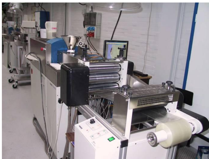
Figur 2.2.1 Foliefremstilling på ekstruder. Granulaterne hældes i tragten og smeltes fortløbende i snekken, der har tre varmezoner. For enden af snekken sidder en flad dyse. Plasten presses ud af dysen og bliver ført rundt om rullerne midt i billede, hvor folien sammenpresses og afkøles, før den oprulles, som det ses på billedets nederste højre hjørne.
