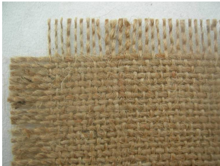
Figur 2.1.1 Referencematerialet, Jutevæv med målt arealvægt på 380 \text{ g/m}^2 .
