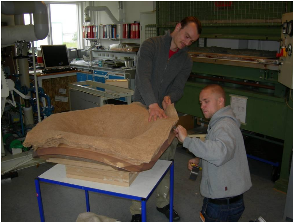
Figur 6.4.2 Christian Dyrman Hansen får hjælp af en studiekammerat under oplægning af den tilfældige orienterede jutefibermåtte "Needled green jute" fra hollandske Enkev BV. Ved at rive de enkelte stykker fra hinanden under oplægningen blev det muligt at fremstille et emne, hvor samlinger ikke kunne ses i overfladen på det konsoliderede emne.
