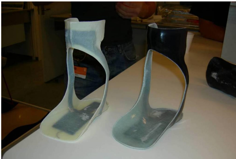
Figur 6.2.4: Til venstre emne baseret på EPOBIOX og til højre et tilsvarende konventionelt emne før montering af spændrem og foring med sål.
