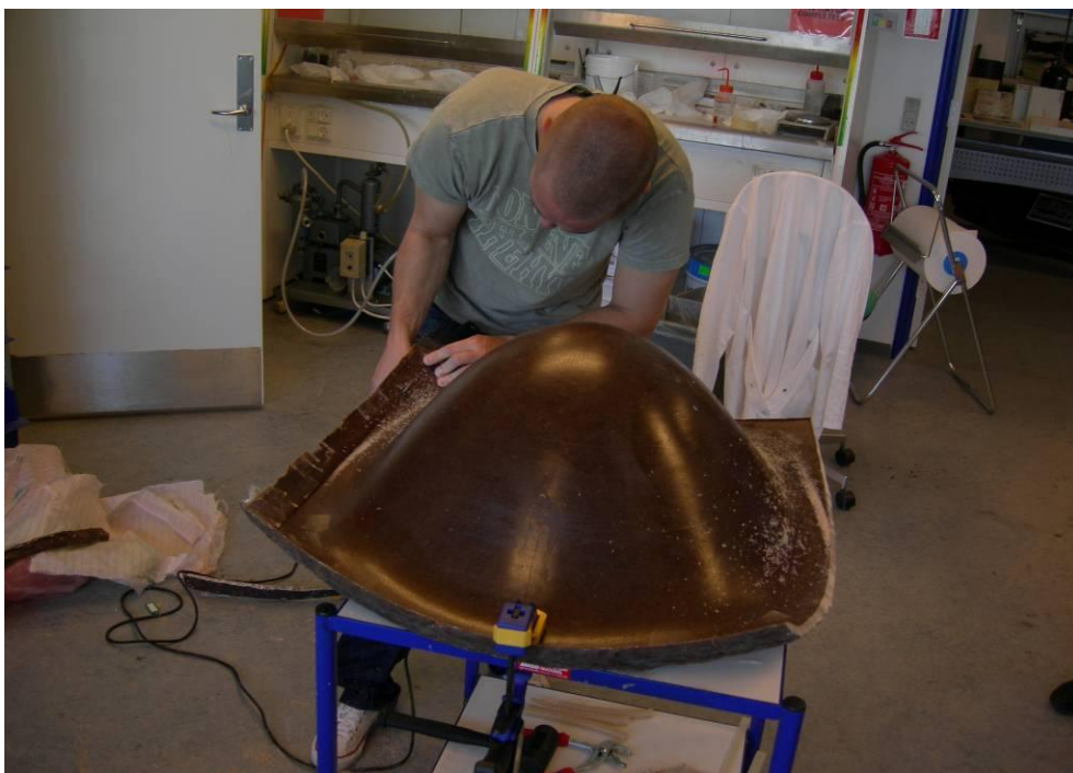
Figur 6.4.3 Bearbejdning af kanten på skallen til "Care". Flot og ensartet overflade uden synlige samlinger blev opnået med en tilfældig orienteret jute måtte.
