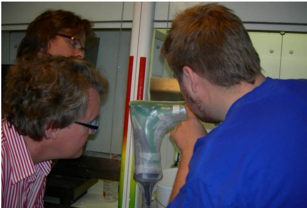
Figur 1.2.3: Vakuum infusion af dropfodsskinne med delvis bio-baseret hærdeplast af typen EPOBIOX på Risø DTU i samarbejde med Henrik Østergaard og Lars Falkenmann fra Ortopæd Ingeniørerne i Roskilde.
