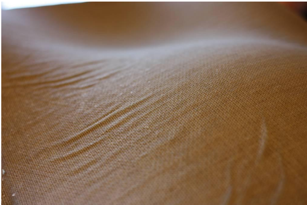
Figur 6.1.3: Øverst og nederst: Uønskede folder i overfladen af det konsoliderede emne. Folderne fremkommer når plasten smelter og materiales kompakteres under processen.
