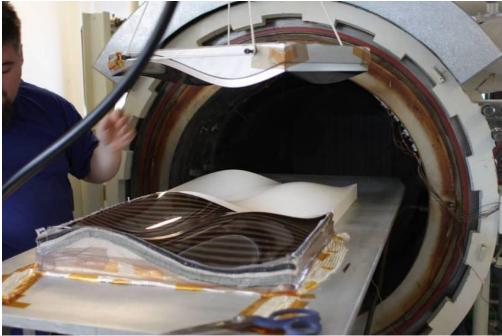
Figur 6.1.10: Afformning af autoklavekonsolideret emne. Den øverste formparat blev håndteret med en kran og skånsomt placeret i den hvide silikone part bagerst på autoklaveordet for at undgå ridser i den polerede overflade.
