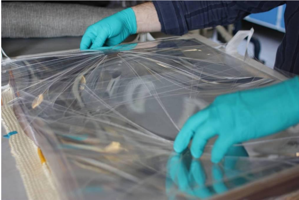
Figur 6.1.4: Slidser i plastfolien gjorde det muligt at få den til at følge emnegeometrien. Materialekvaliteten var kun delvis tilfredsstillende, da det var meget vanskelig at styre slidserne og der forekom en uhomogen fordeling af plastmaterialet i de konsoliderede emner.
