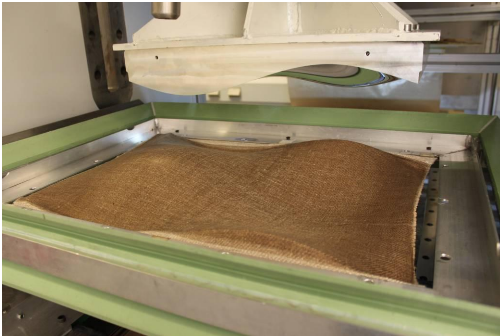
Figur 5.1.9: Pressekonsolideret emne af bio/bio-kompositmateriale i presseenheden. Emne og ramme kan let fjernes fra transportøren og en ny proces påbegyndes. Kanten på emnet kan efterfølgende trimmes ved mekanisk bearbejdning.
