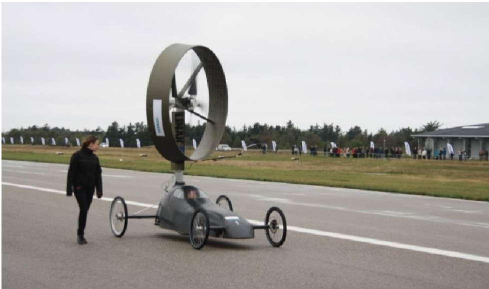
Figur 1.2.2: WinDTUrbineracer med vindmøllevinger der blev fremstillet med kulfiber og en bio-baseret hærdeplast. Til bilen blev der fremstillet fire vinger som hver er 800 mm lang og vejer ca. 250 g.
