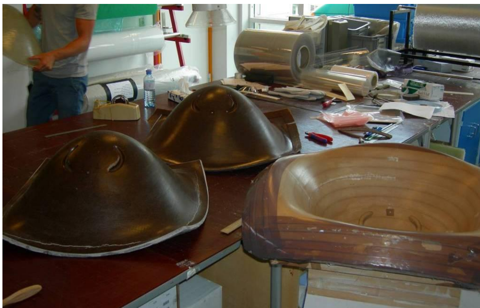
Figur 5.2.2: Nederst til højre ses form til stoleskal fremstillet af MDF, der er limet sammen, bearbejdet og lakeret med flere lag lak for at blive tæt. To skaller fremstillet i formen kan ses på bordet ved siden af.
