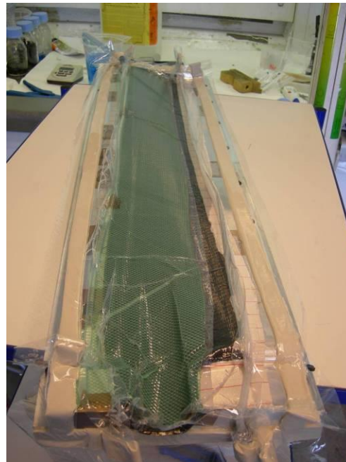
Figur 6.3.2: Venstre: Oplægning af kulfibervæv og ensrette tape i formparten. Højre: Vakuumindekning, hvor "inlet" og "outlet" slangerne er placeret på hver af vingen. Det grønne fordelingsnet dækker uhensigtsmæssig det meste af bredden på vingen.
