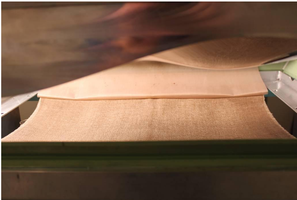
Figur 5.1.6: Øverst: Processen ses fra fronten. Opvarmningen af materialet er afsluttet og hulrummet mellem varmeplanerne ventileret. På billede er varmeplanerne flyttet tilbage og transportøren ved automatisk at flytte materialet til presseenheden. Nederst: Transportøren på vej ind mellem formparterne. Slipfolien er hængslet i forkanten på varmelegemet og bliver samtidig trukket af overfladen på begge sider af det opvarmede klæbrige materiale. Afstanden mellem varmelegemer og presseenhed er afstemt, så slipfolierne er trukket helt af når transportøren er på plads mellem formparterne.
