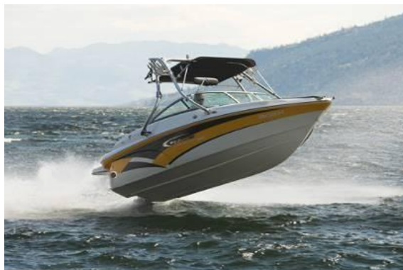
Figur 2.2.2.1: Bådskrog med Envirez® bio-baseret resin. Kilde:CompositesWorld 7/22/2008
