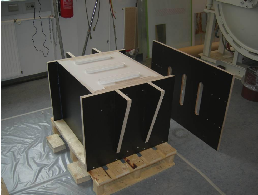
Figur 6.5.3 Støbning af silikoneformen. Kassen blev skruet sammen og samlinger yderligere tætnet for at undgå udsivning. På billede er top-pladen fjernet og står til højre bag formen. De tre afstøbninger af hullerne i toppladen blev efterfølgende brugt til at fiksere og støtte silikoneformen.
