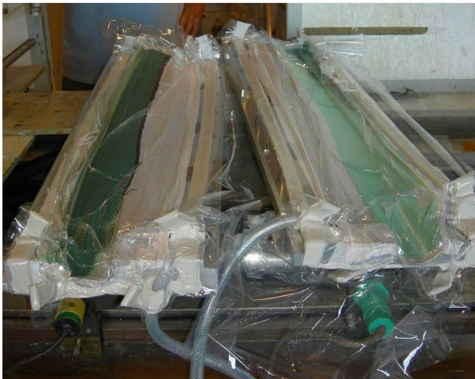
Figur 6.3.3: Vakuumindekning af begge vingeform og samtidig vakuuminfusion. Fordelingsnettet dækker kun ca. halvdelen af bredden på vingen, hvilket resulterede i en bedre vædning af fibrene i overfladen på emnet.
