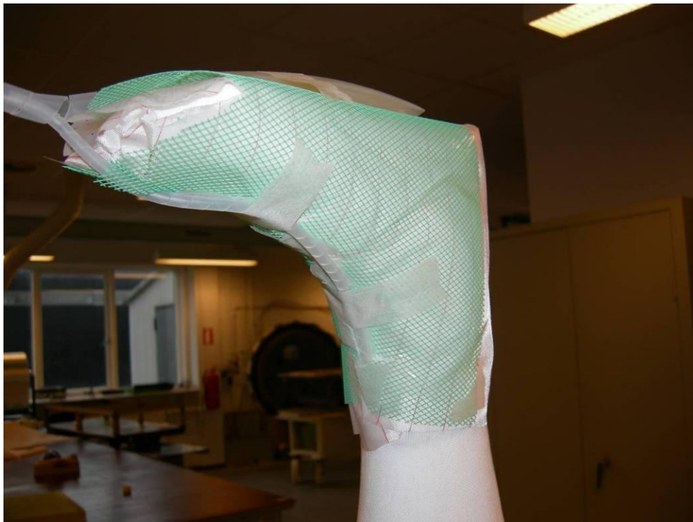
Figur 6.2.1: Dropfodsskinne oplagt på kundespecifik gipsafstøbning ved brug af konventionelle forstærkningsmaterialer. Øverst til venstre ses "inlet" slangen, der forgrener sig over både sål og vrist. Umiddelbart oven på oplæget blev der placeret en peel-ply slipfolie og for at lette afformningen blev der mellem peel-ply og det grønne fordelernet placeret en tynd hul-slipfolie. Hulfolien medfører at fordelernet nemmere kan fjernes når plasten er hærdet. Da EPOBIOX resinen er relativt høj viskøs er stort set hele emnet dækket med det grønne fordelernet. "Outlet" slangen kan ikke ses på billede, men den var placeret umiddelbart i underkanten af billede og kan ses på Figur 6.2.2.
